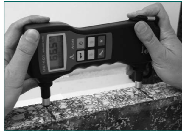
Figura 8.- Medición de tiempos de transmisión de ultrasonidos sobre probetas de laboratorio con aparato de transductores DPC (UK1401): a) Probeta de SMA 11, h=150 mm, z=50 mm; b) Probeta de AC16 S, h=150 mm, z=50 mm.
