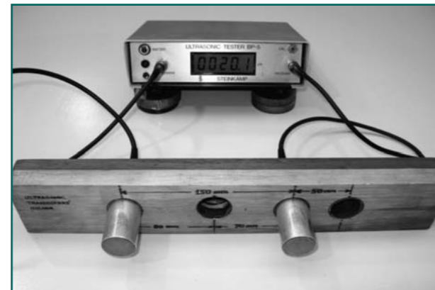
Figura 7.- Aparatos de ultrasonidos utilizados en la investigación: a) Instrumento JME UK1401 con transductores tipo DPC; b) Equipo STEINKAMP BP-5 con transductores CPC.
