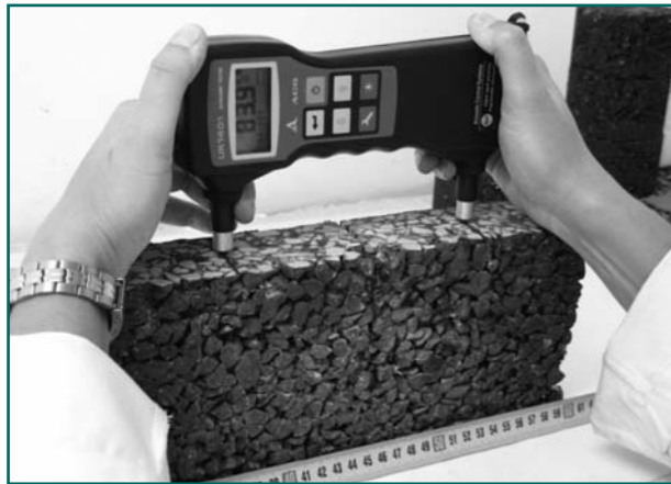
Figura 8.- Medición de tiempos de transmisión de ultrasonidos sobre probetas de laboratorio con aparato de transductores DPC (UK1401): a) Probeta de SMA 11, h=150 mm, z=50 mm; b) Probeta de AC16 S, h=150 mm, z=50 mm.
