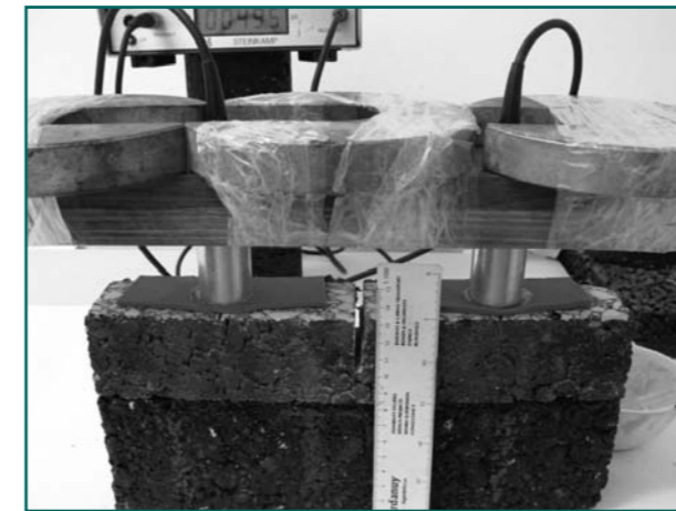
Figura 9.- Medición de tiempos de transmisión de ultrasonidos sobre probetas de laboratorio con aparato de transductores CPC (BP-5); B=150 mm: a) Probeta de PA 11, h=150 mm, z=50 mm; b) Probeta de AC16 S, h=60+60 mm pegadas, z=60 mm.
