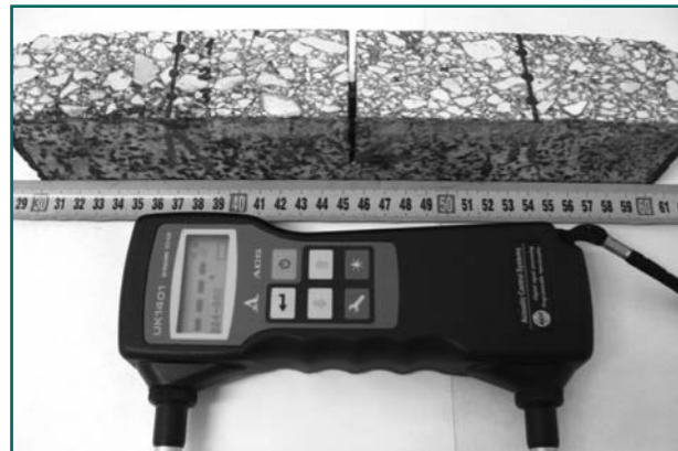
Figura 7.- Aparatos de ultrasonidos utilizados en la investigación: a) Instrumento JME UK1401 con transductores tipo DPC; b) Equipo STEINKAMP BP-5 con transductores CPC.
